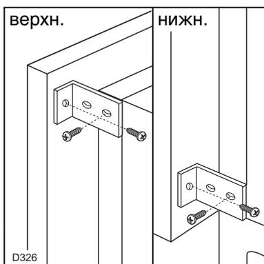
1. Прикрепите боковые панели к задней панели прибора с помощью фиксирующих скоб.
