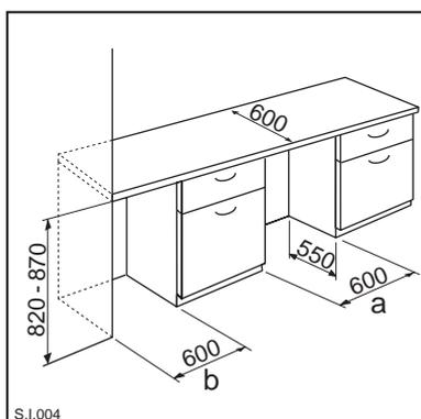
Размеры монтажного проема для встраивания должны соответствовать указанным на рисунке. Прибор может быть установлен между двумя предметами мебели (а) или замыкать мебельный ряд (b).
