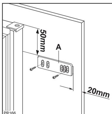
5. Приложите направляющую (A) на внутреннюю сторону двери шкафа, сверху и снизу, как показано на рисунке, и отметьте положение крайних отверстий. Подготовив отверстия, установите направляющую при помощи входящих в комплект винтов.
