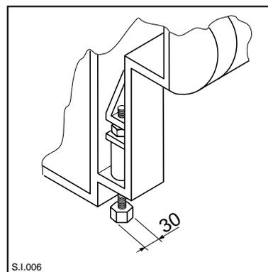
3. Холодильник снабжен регулируемыми ножками. Чтобы настроить высоту прибора в соответствии с высотой монтажного проема (макс. 870 мм), вкрутите или выкрутите регулируемые ножки во всех четырех нижних углах прибора.
