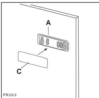
6. Установите и защелкните крышку (C) на направляющей (A).
