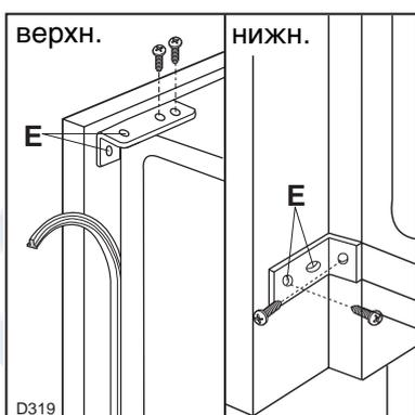
2. Прикрепите прибор к столешнице или к боковым панелям с помощью фиксирующих скоб (E). Затем между морозильником и прилегающими панелями мебели проложите ленту уплотнителя.
