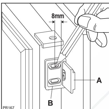
7. Откройте дверь морозильника и шкафа приблизительно на 90°. Вставьте кронштейн (B) в направляющую (A). Удерживайте двери прибора и шкафа вместе и отметьте отверстия, как показано на рисунке. Снимите кронштейны и просверлите отверстия диаметром 2 мм на расстоянии 8 мм от наружной кромки двери. Вновь установите кронштейн на направляющую и закрепите входящими в комплект винтами.
