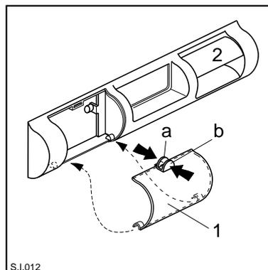
Фильтр можно снять и промыть водой.
